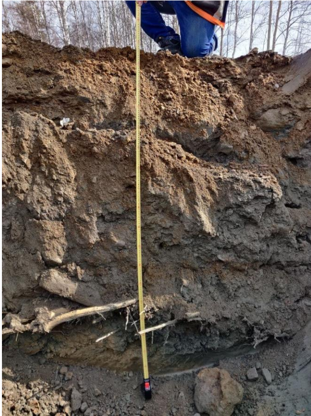
Kuva 19. Koekuopassa KK4 havaittu puuta.
