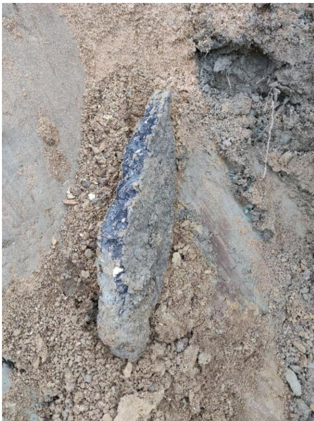
Kuva 26. Koekuopassa KK5 havaittua asfalttia.
