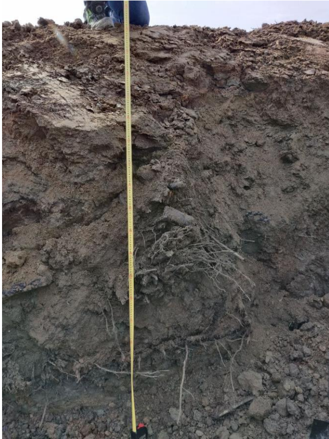
Kuva 23. Koekuoppa KK5 etelä seinämää. Seinämässä nähtävillä eloperäistä aineista sisältävät kerrokset.
