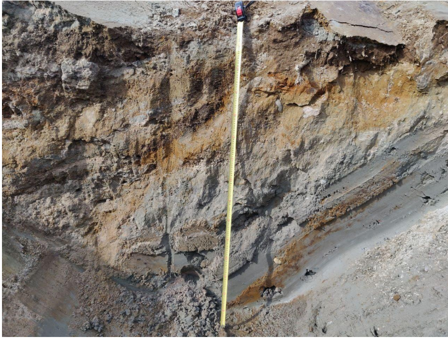
Kuva 9. Koekuoppa KK2 seinämää. Maa-ainesten joukossa näkyy eloperäistä ainesta.
